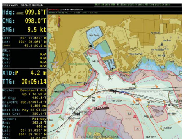
ΣΧΗΜΑ 18. Εικόνα Οθόνης Συστήματος ECPINS® W. Απεικονίζεται η χάραξη δρομολογίου και η επισήμανση των απαγορευμένων περιοχών λόγω βάθους ασφαλείας με χρήση γραμμών θέσεως ασφαλείας (Limiting Danger Lines) [12]
